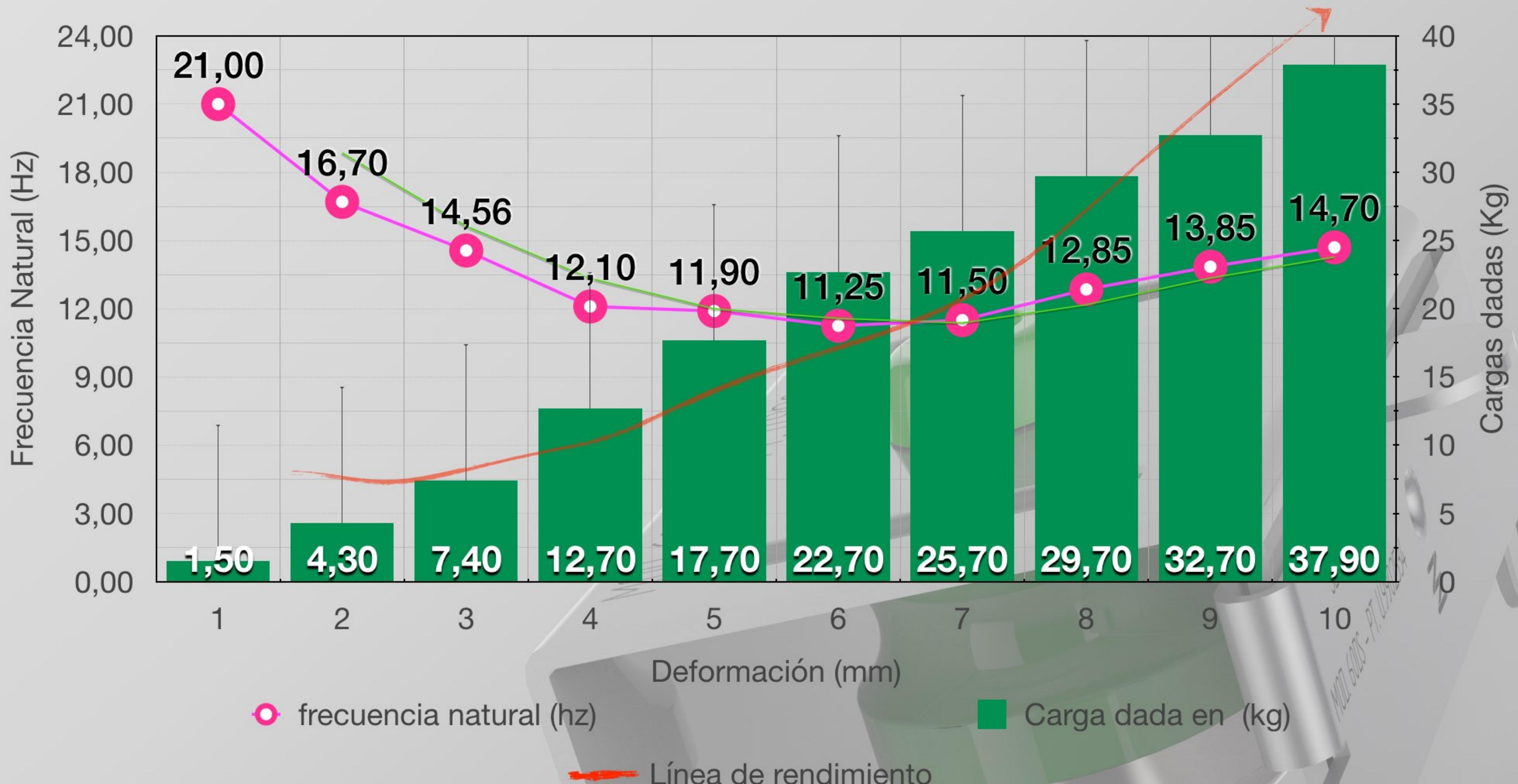
**Conclusión:** Se dispone el amortiguador **MEGOL VERDE** sobre el pistón hidráulico para su ensayo a compresión, aplicando la carga de manera progresiva a una velocidad de 2 mm/min, hasta un máximo de 0,4 kN. Se adquieren los datos de carga y desplazamiento.
