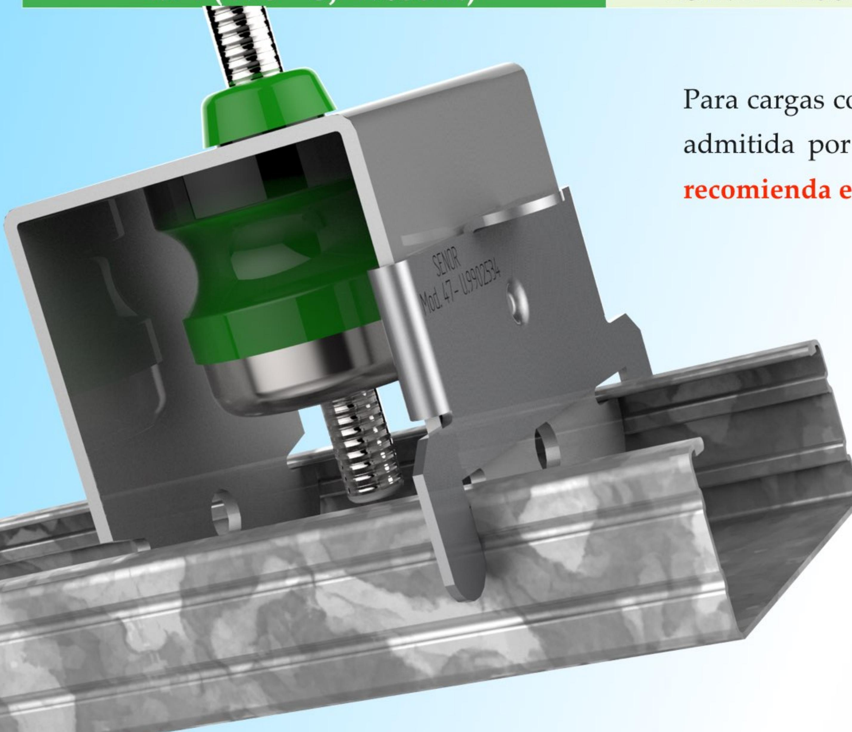
Para cargas comprendidas entre 80N hasta 300N de carga máxima admitida por SENOR para el **MEGOL verde**. **El fabricante no recomienda en ningún caso sobrepasar el valor máximo.**
