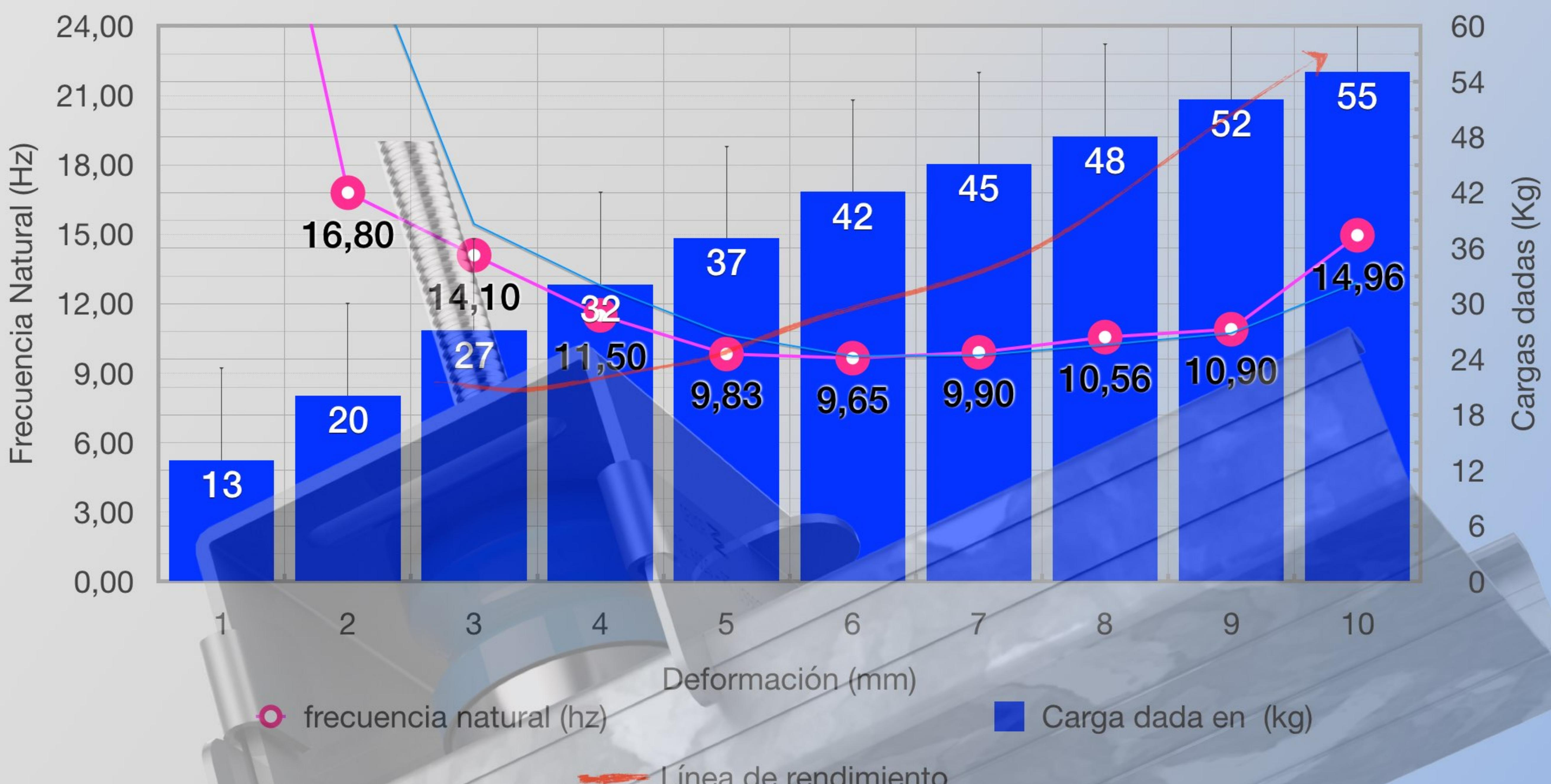
**Conclusión:** Se dispone el amortiguador **MEGOL AZUL** sobre el pistón hidráulico para su ensayo a compresión, aplicando la carga de manera progresiva a una velocidad de 2 mm/min, hasta un máximo de 0,6 kN. Se adquieren los datos de carga y desplazamiento.
